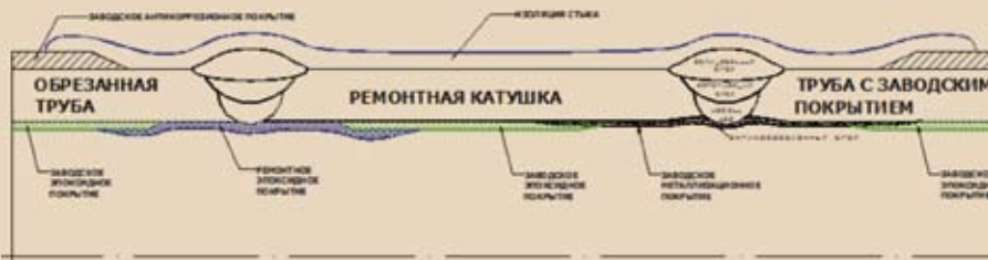
Рис. 3. Схема расположения изоляционных материалов на ремонтном участке
