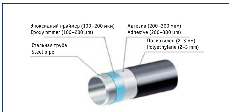
Рис. 1. Схема трехслойного изоляционного покрытия
