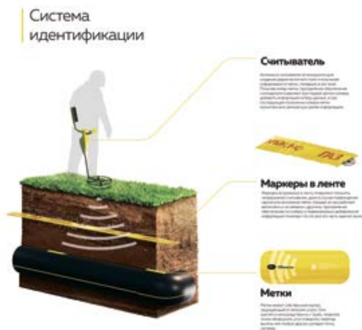
Рис. 1. Комплекс оборудования для радиочастотной идентификации трубопроводов
