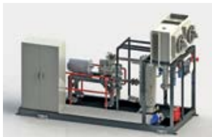
Рис. 1. 3D-модель МГКУ на открытой раме
