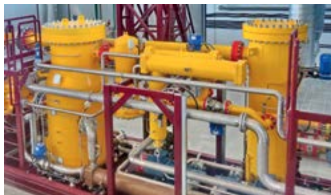
Фото 2. Многоступенчатая система сепарации газа, усиленная фильтром-скруббером
