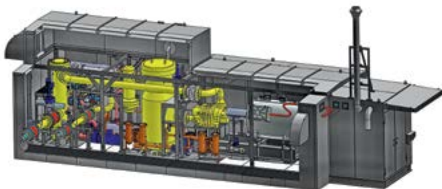
Модель компрессорной установки попутного газа для турбин энергоцентра Усинского месторождения (ООО «ЛУКОЙЛ-Коми»)
