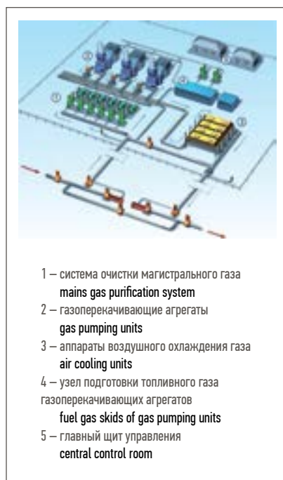
Рис. 1. Схема компрессорной станции Fig. 1. Compressor station layout
