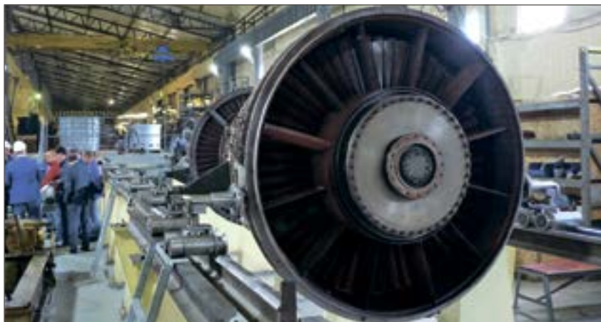
Цех по ремонту газотурбинных двигателей
