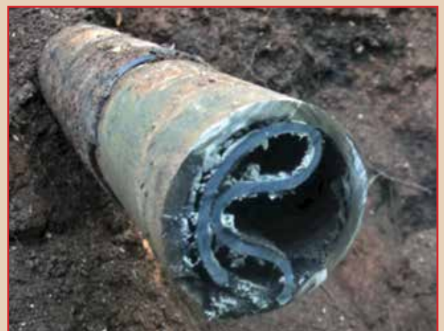
Рис. 3. Проблемы, вызываемые оплавлением полиэтиленовой футеровки металлопластмассовых труб: внутренняя коррозия в околошовной зоне (а) и отслаивание футеровки из-за попадания под нее перекачиваемой продукции (б)
