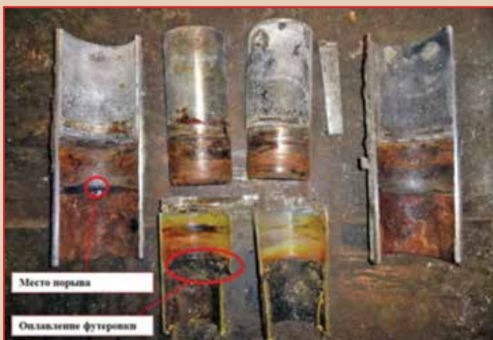
Рис. 3. Проблемы, вызываемые оплавлением полиэтиленовой футеровки металлопластмассовых труб: внутренняя коррозия в околошовной зоне (а) и отслаивание футеровки из-за попадания под нее перекачиваемой продукции (б)
