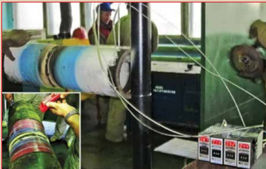
Рис. 4. Стендовые испытания термоиндикаторных составов
