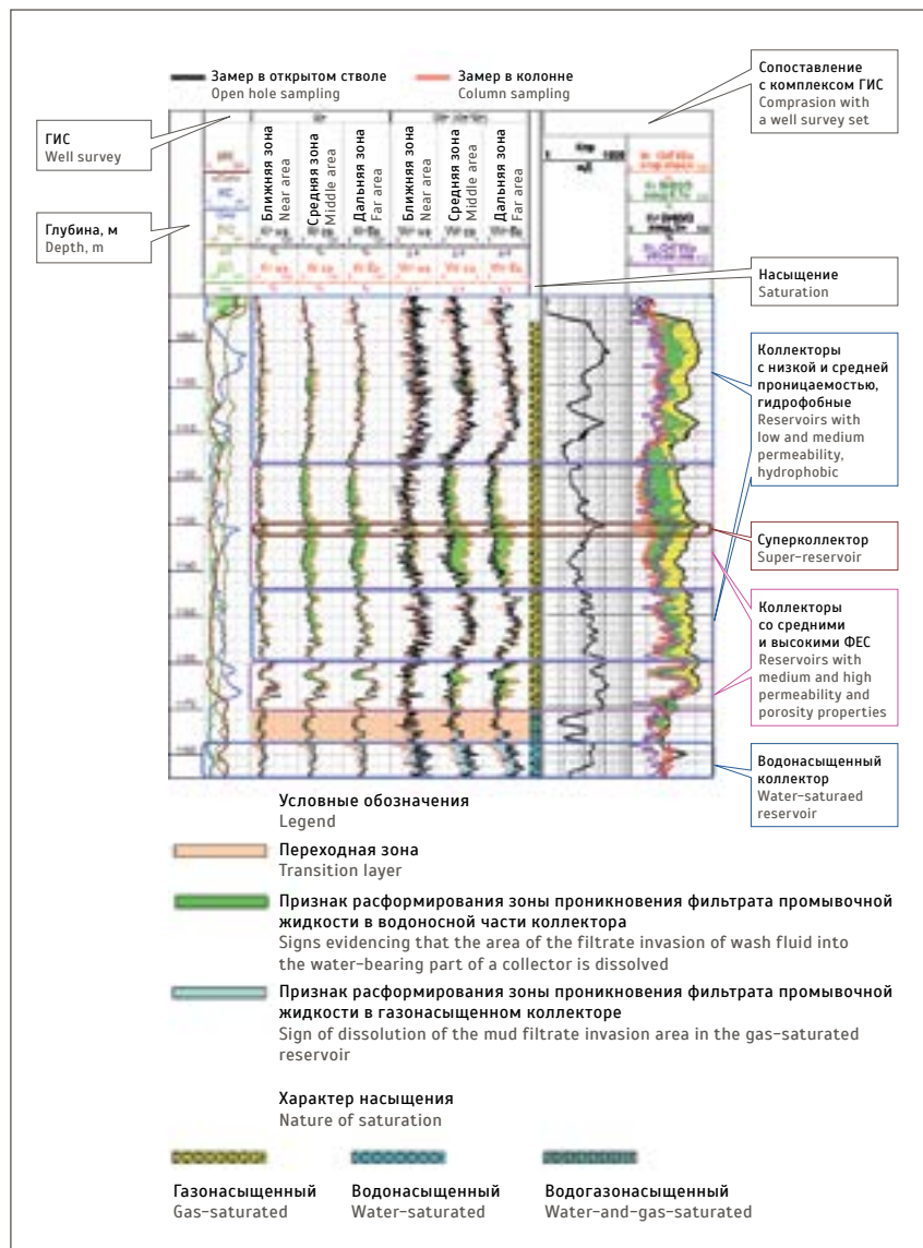
Рис. 3. Сопоставление результатов интерпретации по методике МНК- K_r по временным замерам в открытом стволе и в заглушенной скважине после обсадки и цементирования первой колонны Fig. 3. Comparison of the results of the interpretation with the use of the Multidetector Neutron Logging method by time-domain measurements in the open hole and the cased hole after casing and cementing the first column
