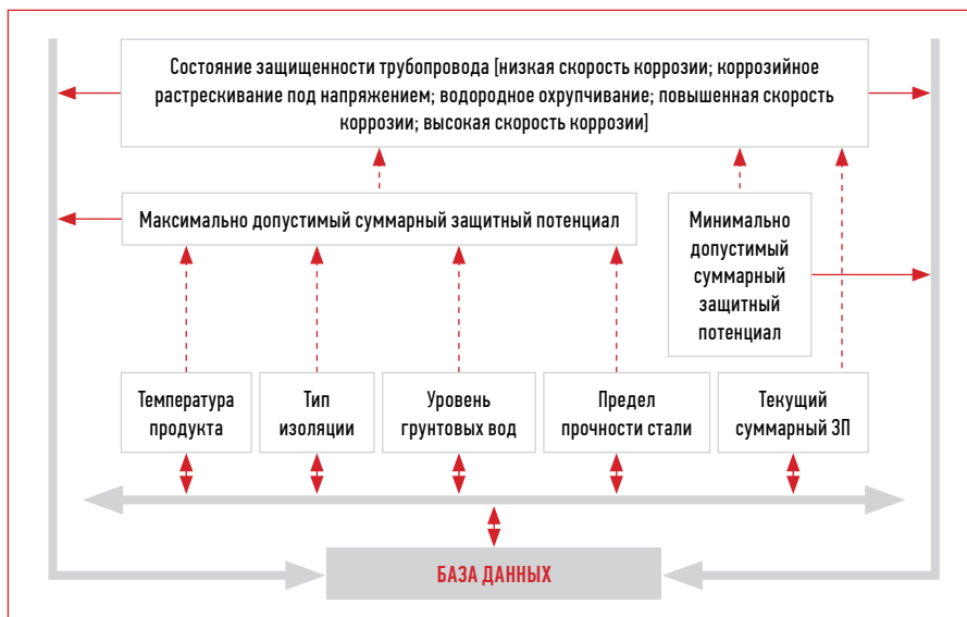
Рис. 2. Модель определения состояния защищенности трубопровода
