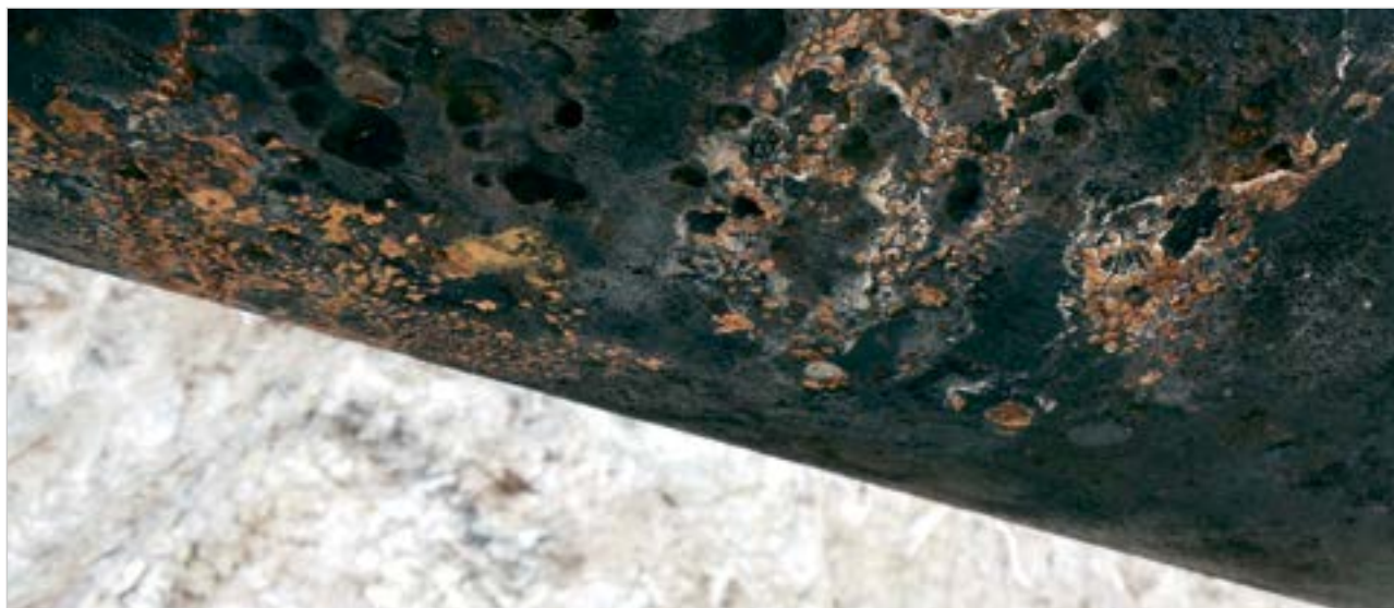
Рис. 2. Наличие многочисленных язв в зоне влияния блуждающих токов
