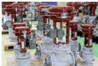
Рис. 1. Седельные регулирующие клапаны с мембранными исполнительными механизмами и электропневматическими смарт-позиционерами
