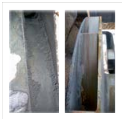
Рис. 3. Рабочее колесо до и после промывки
