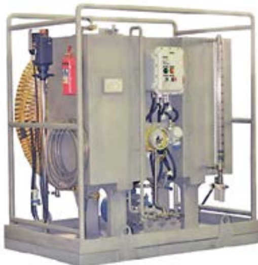
Рис. 1. Установка УПР-ТПГ стационарная для промывки ЦБК
