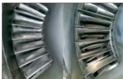
Рис. 4. Лопатки ВНА и рабочие лопатки 1-й ступени ГВТ до и после промывки раствором НТ–110
