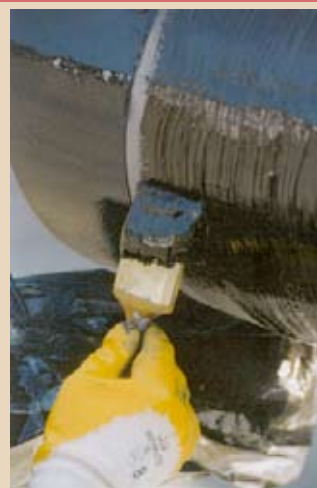
Фото 8. Заводская изоляция ЗАО «Сибпромкомплект», г. Тюмень, 2005. Покрытие Protegol EP-Coating 130HT
