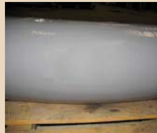
Фото 8. Заводская изоляция ЗАО «Сибпромкомплект», г. Тюмень, 2005. Покрытие Protegol EP-Coating 130HT
