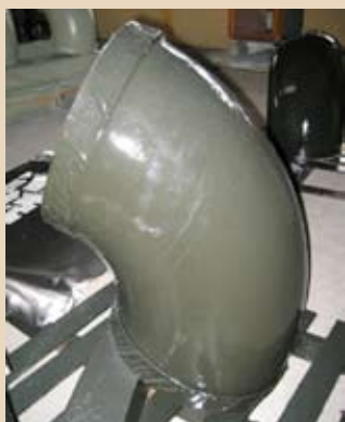
Фото 3. Заводская изоляция ОАО «Трубодеталь». Покрытие Protegol UR-Coating 32-55R, 2004 г.
