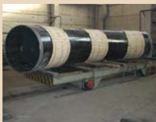
Фото 4. Заводская изоляция ООО «Нефтегаздеталь», г. Чайковский, 2005. Покрытие Protegol UR-Coating 32-55H
