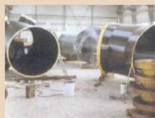
Фото 10. Заводская изоляция. Покрытие Protegol UR-Coating 32-55
