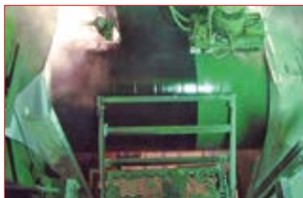
Рис. 1. Выход труб из камеры нанесения эпоксидного порошка
