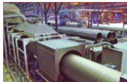
Рис. 2. Индукционный нагрев труб перед нанесением эпоксидного порошкового покрытия
