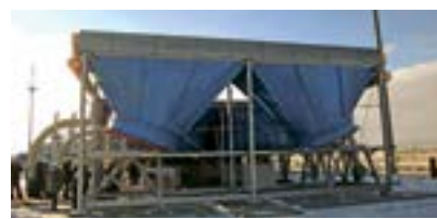
Рис. 1. Опытный образец аппарата воздушного охлаждения газа для линейных компрессорных станций Fig. 1. Prototype of advanced air cooling unit for linear compressor stations
