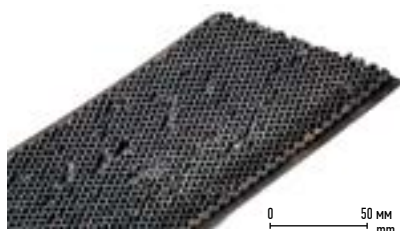
Рис. 8. Сотовая вставка турбины агрегата LM2500 Коберра Fig. 8. Honeycomb insert of a turbine of the LM2500 Coberra unit
