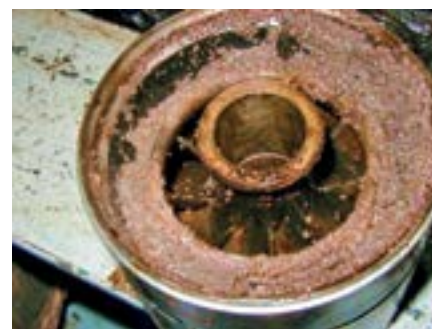
Рис. 2. Рабочая ступень электроцентробежного насоса, забитая проппантом вследствие обратного выноса наполнителя трещины в скважину
